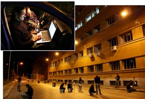
Hemos desarrollado un sistema de medida automática de iluminación de vías públicas mediante un luxómetro colocado sobre un automóvil que toma medidas mientras éste se desplaza por las calles. Los datos se georreferencian con coordenadas obtenidas con GPS durante el recorrido.
